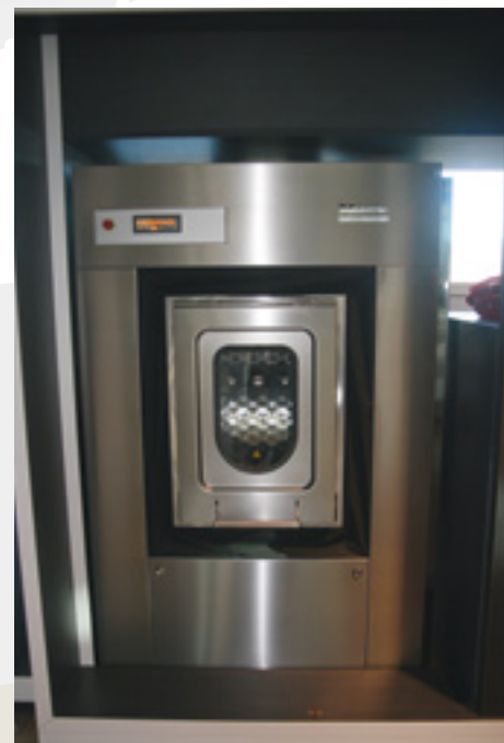
Barrieremaskin: Skitne innsatsklær legges i maskinen på den ene siden av veggen, og tas ut rene på den andre siden av veggen.
